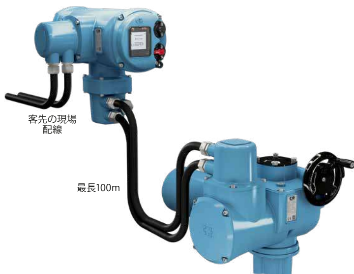
アクチュエータから100mの距離に取り付けたセントロニックモジュール
