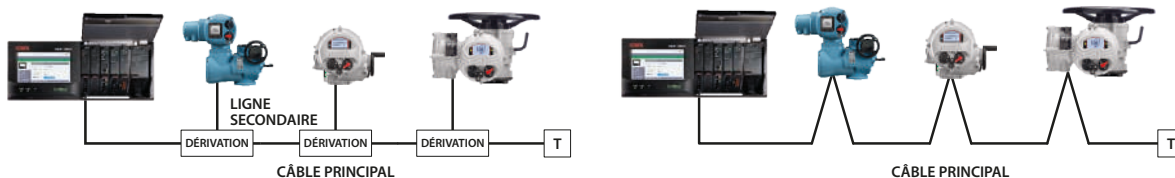
Fig 8.1.1: Topologie de la liaison de données RS-485 - Canal unique
