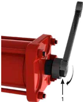
5. 揺動角を下げる場合は、ストップボルト(1)を時計方向に回して下さい。
