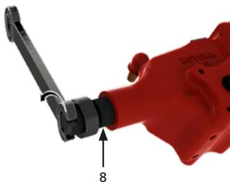
5. 揺動角を下げる場合は、ストップボルト(8)を時計方向に回して下さい。
