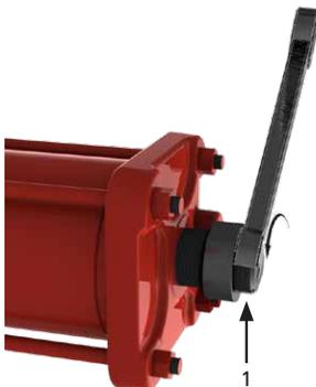
6. Überprüfen Sie die neu erhaltene Stellung mit einem Hub in Schließrichtung
