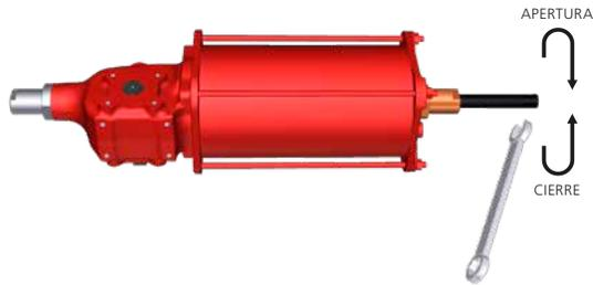
Fig 12.4 Actuador en «fallo cierra» con control manual prioritario tipo «M»
