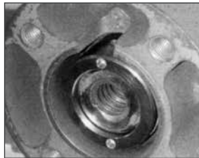
图 4.8 安装在位置1的A型驱动轴套
