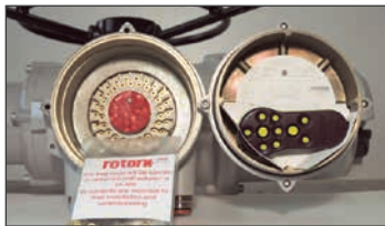
图 6.2 – 装有Rotork版设定器的执行机构。
