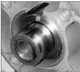
图 4.9 安装在位置2的A型驱动轴套
