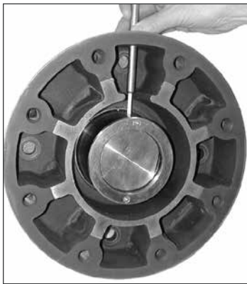
图 4.12 拧紧挡圈固定螺钉
