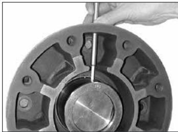
图 4.5 定位固定螺钉
