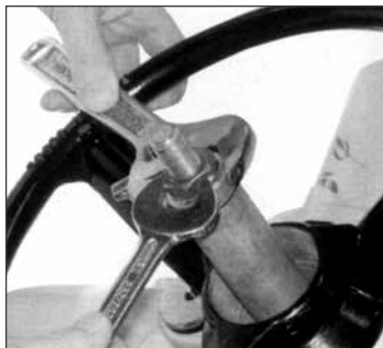
图 5.6 下行动作抑制调节管操作（使用两把扳手）
