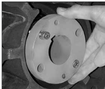
图 4.14 原位B3/B4型驱动轴套
