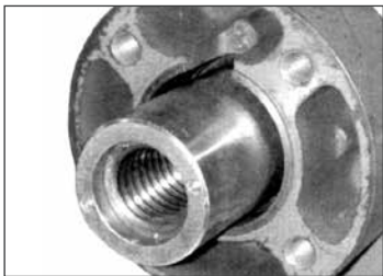
图 4.11 安装在位置3的Z3型驱动轴套
