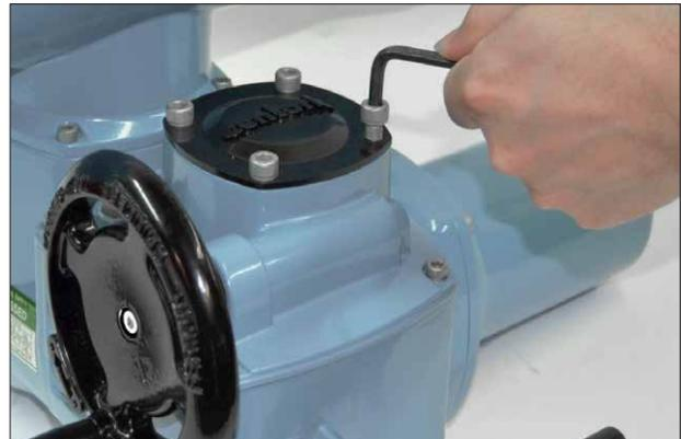
Per valvole con steli salienti è possibile l'installazione di un tubo copristelo. Accertarsi che l'O-ring sia correttamente installato e che il tubo di copertura sia fissato saldamente con i dispositivi di fissaggio in dotazione.
