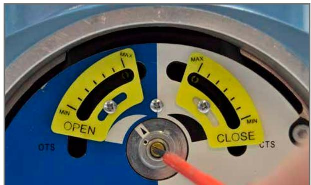
Réglage de la vis de l'embrayage à came du couple.
