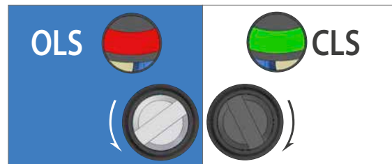
Der Endlagenschaltpunkt ist nahe oder erreicht.
