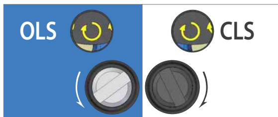
Drehen Sie die OLS/CLS Einstellwelle im Uhrzeigersinn.
