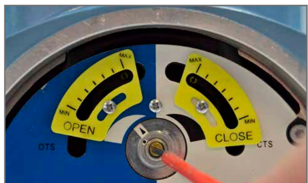
Einstellung der Drehmomentnocke.
