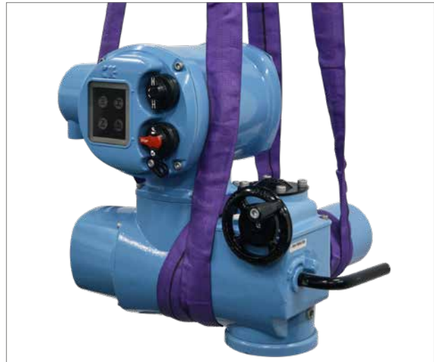
CK Atronik-Antrieb wird in einer Schlinge angehoben.
