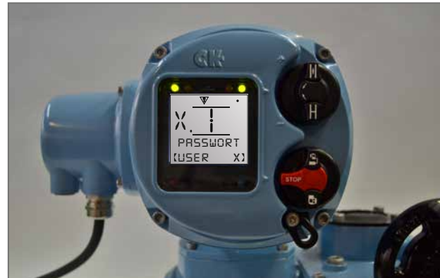
Abbildung 3: Nach der Eingabe des Standardpassworts wird die Zugriffsebene „Benutzer“ bestätigt.
