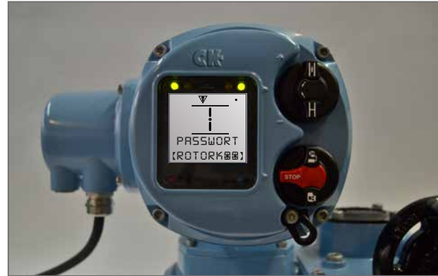
Abbildung 2: Anzeige des Standardpassworts im Bearbeitungsmodus
