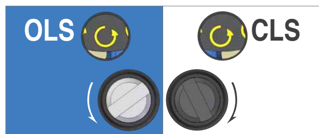
Die OLS-/CLS-Justierwelle gegen den Uhrzeigersinn drehen.
