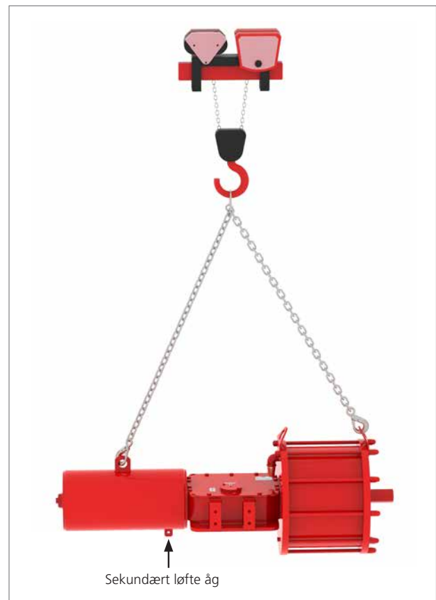
Fig 7.1 Løft (enkeltvirkende aktuator op til størrelse 130)
